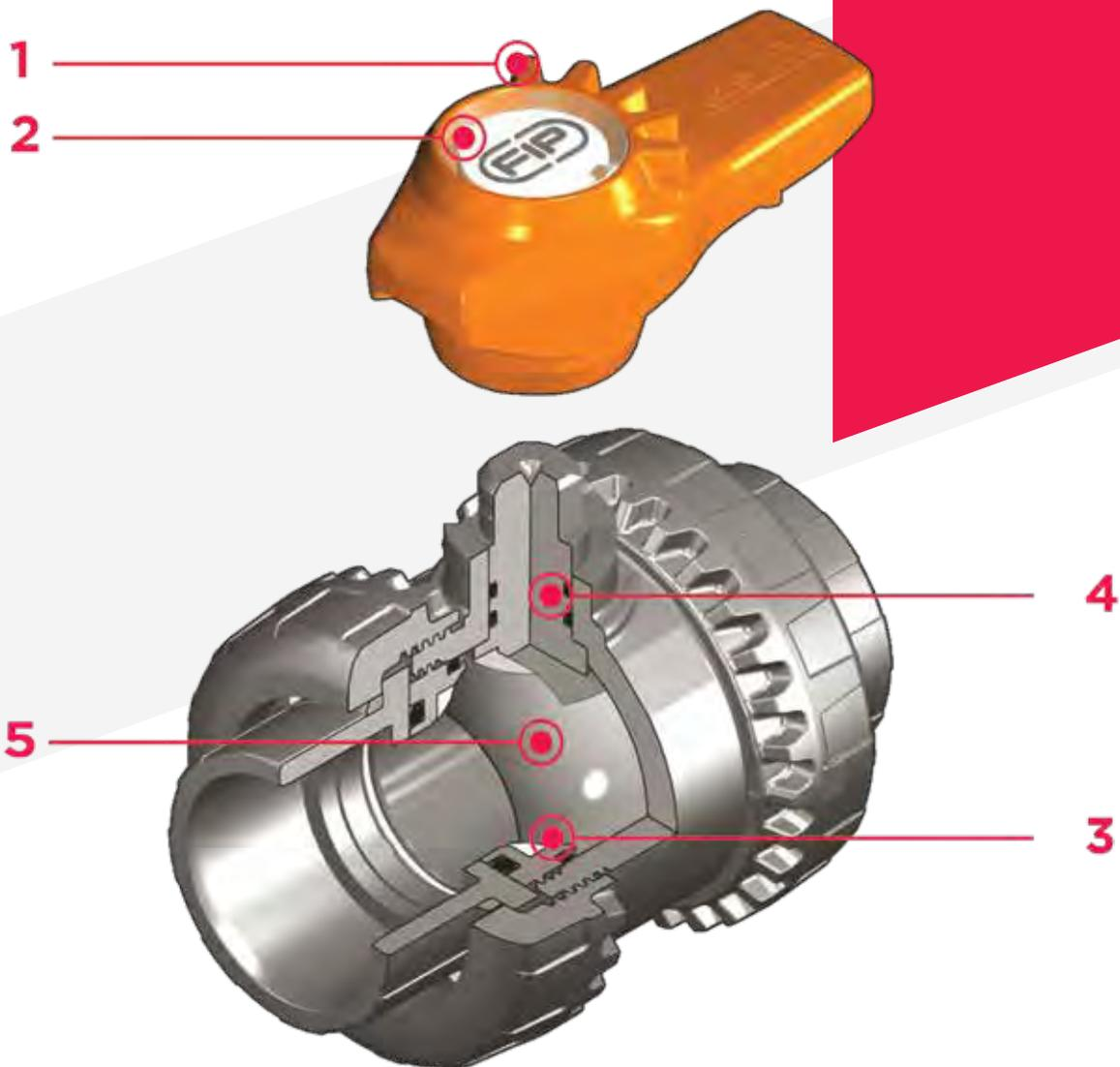
**1** **Maniglia ergonomica multifunzione Easyfit** biposizionabile con **comando per registrazione del serraggio delle ghiere** e utilizzabile come chiave per la **regolazione del supporto delle guarnizioni di tenuta della sfera**. L'uso della maniglia è particolarmente indicato per operazioni di **manutenzione** ove si operi in **spazi limitati** e di difficile accessibilità
